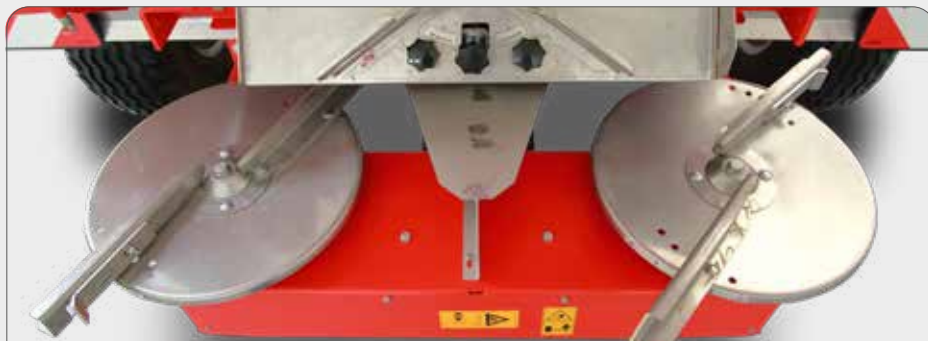
Stainless steel discs with adjustable vanes Нержавеющие диски с регулируемыми лопастями
