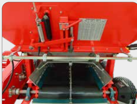
Hydraulic tail gate Гидравлический задний затвор
