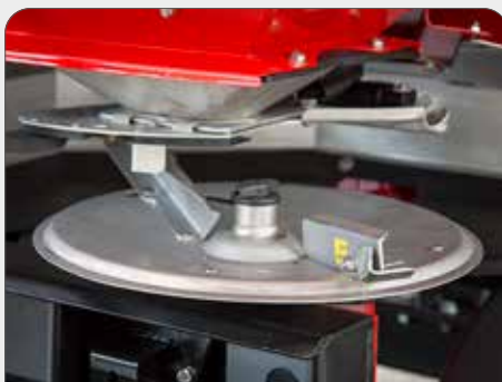
Stainless steel discs with adjustable vanes Нержавеющие диски с регулируемыми лопастями
