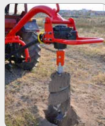
Replaceable knives and point Сменные ножи и долоты
