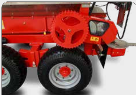
Movement wheel provides smooth and accurate application norm. Колесо движения обеспечивает плавность и четкая норма применения.
