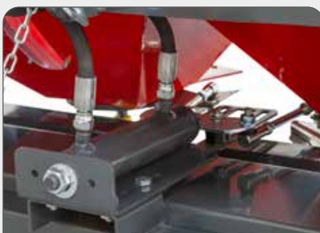
Hydraulic shut off vents Гидравлические запорные вентили
