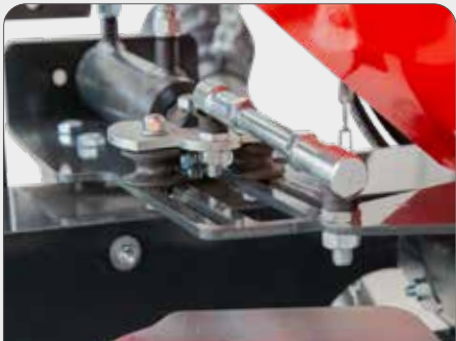
Hydraulic Opening and Closing System Гидравлическая система открытия и закрытия
